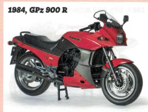
Mit der auch aus dem Hollywood-Streifen «Top Gun» bekannten GPz 900 R führte Kawasaki erstmals Wasserkühlung und Vierventiltechnik ein.
