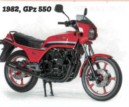
Revolutionär war an der GPz 550 die Uni-Track-Schwinge. Sie war damit das erste Strassen-Bike mit Umlenkhebelsystem.
