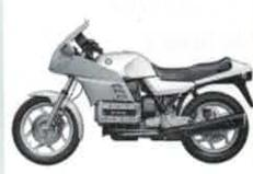
**Technik-Highlights der 1980er** – Die vollverkleideten K-100-Modelle RS, RT und LT waren technisch höchst anspruchsvoll; Benzineinspritzung und ABS-Bremssystem (ab 1988) setzten Massstäbe; möglich machte die Grossinvestitionen der Erfolg von BMWs Pkw-Sparte, von der so manche Technologie herüberkam.
