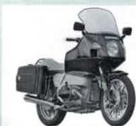
**Aerodynamik punktet** – 1978 schob BMW mit der ebenfalls 70 PS starken R 100 RT eine aerodynamisch ausgefeilte Langstrecken-Tourenmaschine nach; die Scheibe war verstellbar, Luftdüsen in der Frontverkleidung waren verschliessbar. Massgenaue Seitenkoffer vereinfachten die Gepäckmitnahme.
