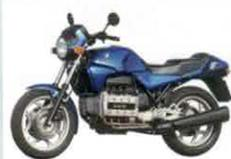
**Vier Zylinder in Reihe** – Nachdem Honda bereits einen Vierzylinder-Boxermotor im Programm hatte, setzte BMW für seine neue K-Baureihe auf einen Vierzylinder-Reihenmotor; er wurde in Längsrichtung flach liegend installiert. Erstes Modell war ab 1983 die unverkleidete K 100 (987 ccm, 90 PS, 239 kg, 215 km/h). Auch hier eine Einarmschwinge.
